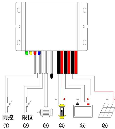
按图中接线标号顺序对太阳能系统部件依次进行安装，同时注意各部件的
