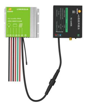
为了安全,请按照负载、蓄电池、光电池的接线顺序进行接线。
