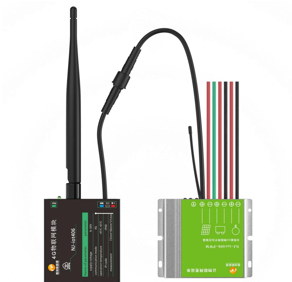
为了安全，请按照负载、蓄电池、光电池的接线顺序进行接线。
